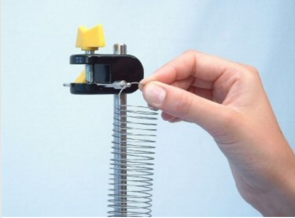
Enganchar el muelle en el perno de retención
