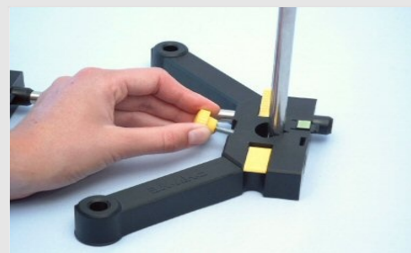
Fijación con la ayuda del tapón de rosca
