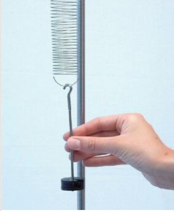
Charger le ressort avec différentes masses m
