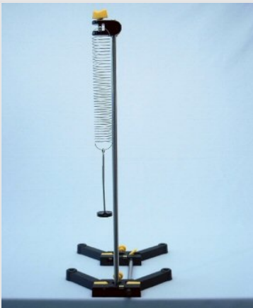
Montage d'expérience avec pendule à ressort hélicoïdal
