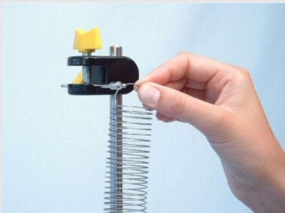
Accrocher le ressort hélicoïdal dans le boulon de retenue
