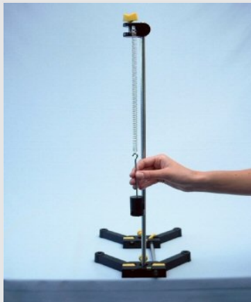
Dévation du ressort avec la constante de ressort 20 \text{ N/m}
