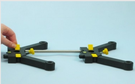
Assemblage de la base du trépied
