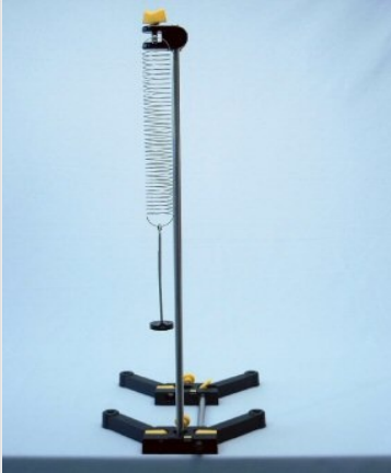
Montage d'expérience avec pendule à ressort hélicoïdal
