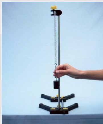
Розтягування пружини жорсткістю 20 Н/м
