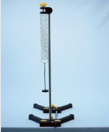
Експериментальна установка маятника
