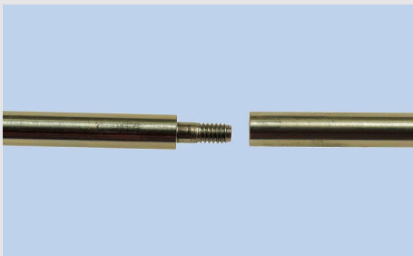
Verschrauben der Stativstangen
