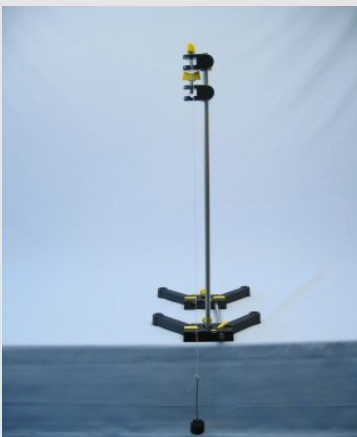
Montage d'expérience pour l'étude du pendule mathématique
