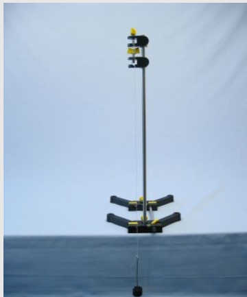
Математикалық маятникті зерттеуге арналған эксперименттік қондырғы
