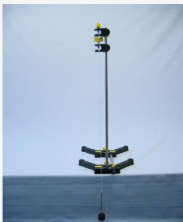
Математикалық маятникті зерттеуге арналған эксперименттік қондырғы
