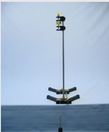
Математикалық маятникті зерттеуге арналған эксперименттік қондырғы
