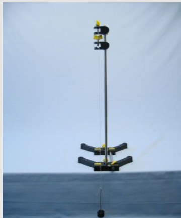
Экспериментальная установка для исследования математического маятника
