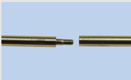
Скручивание штативных стержней
