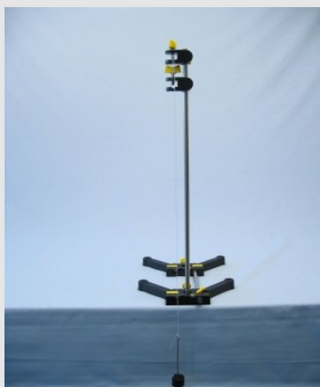
Экспериментальная установка для исследования математического маятника
