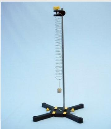
Versuchsaufbau zur Ermittlung der Eigenfrequenz des Federpendels
