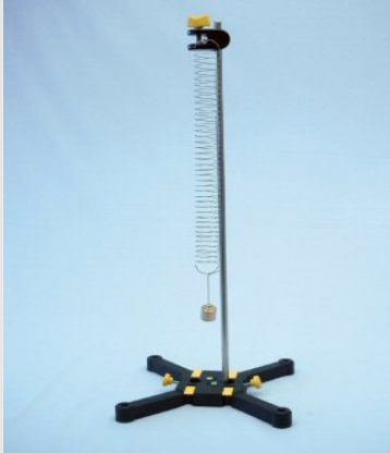
Configuración de prueba para determinar la frecuencia natural del péndulo de resorte
