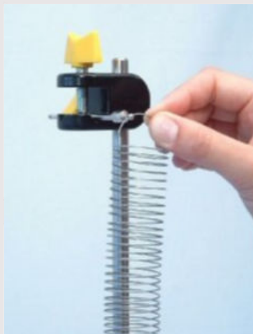
Крепежный болт с пружиной в двойной муфте
