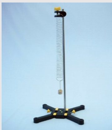
Експериментальна установка для визначення коливань
