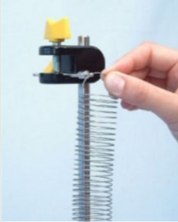
Кріпильний болт із пружиною в подвійній муфті
