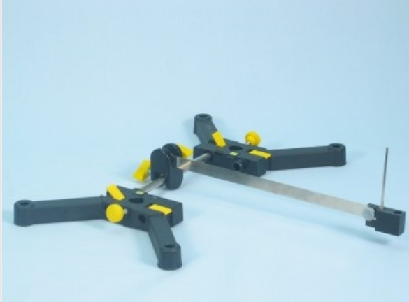
Versuchsaufbau zur graphischen Untersuchung der Blattfeder
