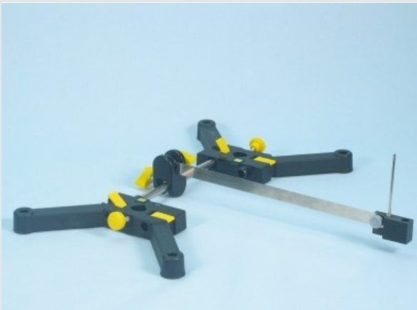
Versuchsaufbau zur graphischen Untersuchung der Blattfeder
