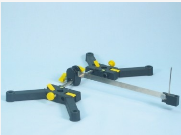
Proefopstelling voor het grafisch onderzoek van de bladveer
