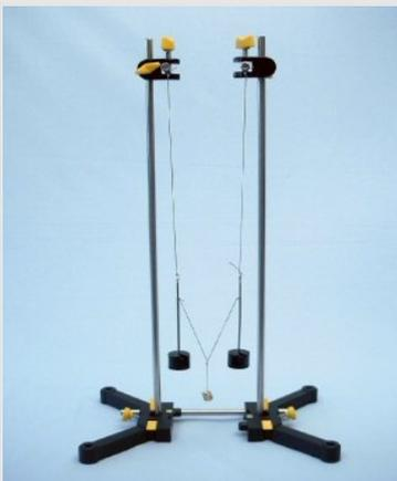
Versuchsaufbau zur Untersuchung der gekoppelten Pendel
