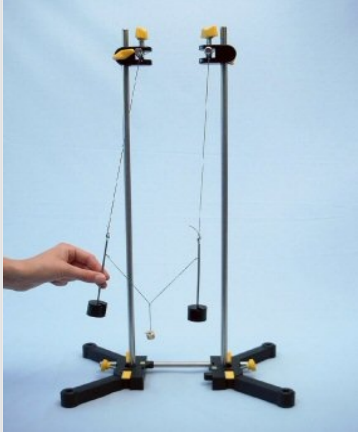
Desviación del péndulo del hilo
