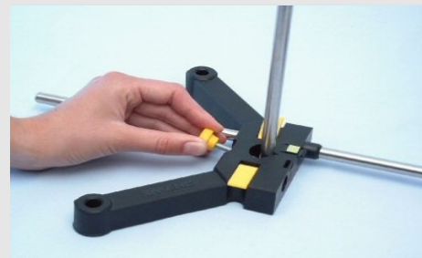
Fijar la barra de soporte
