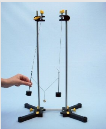
Desviación del péndulo del hilo
