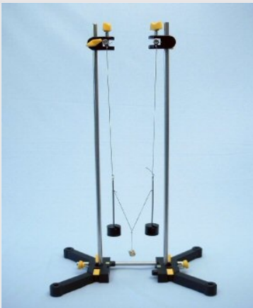
Proefopstelling voor het onderzoek van gekoppelde slingers
