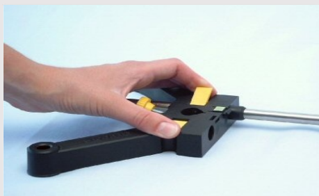
Соедините основу штатива с штативным стержнем
