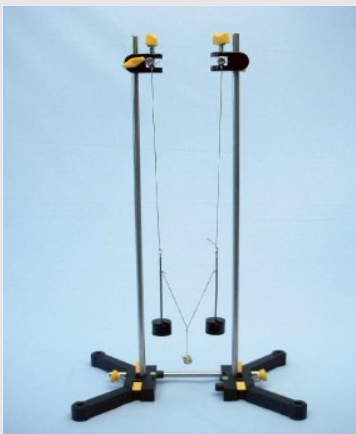
Экспериментальная установка для исследования связанных маятников
