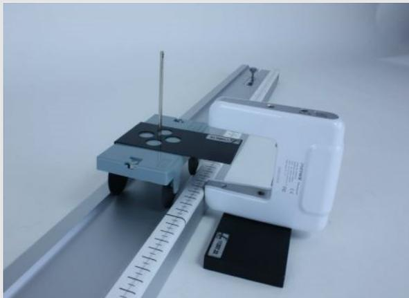
Conectar la placa adaptadora y la barrera de luz
