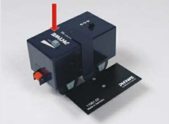
Abschaltblende am Messwagen befestigen
