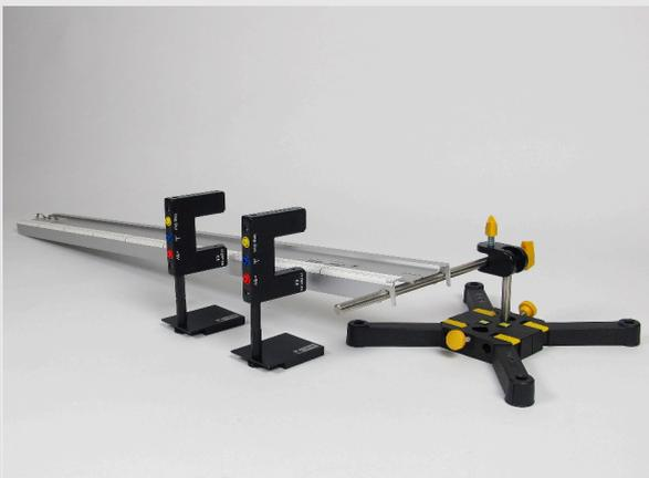
Gabellichtschalter mittels Distanzbolzen an Adapterplatte befestigen
