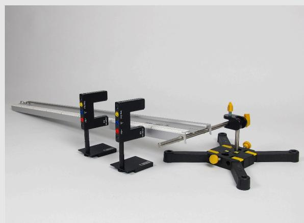
Fijar las dos barreras fotoeléctricas con dos pernos espaciadores cada una a las placas de tal manera que las barreras fotoeléctricas se puedan colocar fácilmente en la zona superior de la calzada.
