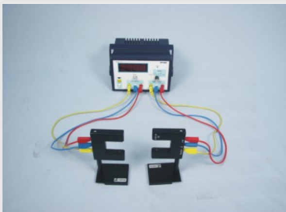
Подключение световых барьеров к таймеру
