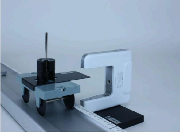
Conexión de placas adaptadoras con barrera de luz en forma de horquilla
