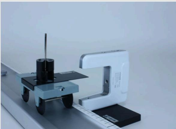
Connecter les plaques d'adaptation avec les barrages optiques en fourche
