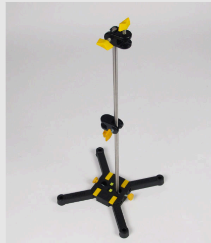
Закрепить двойные муфты на штативном стержне
