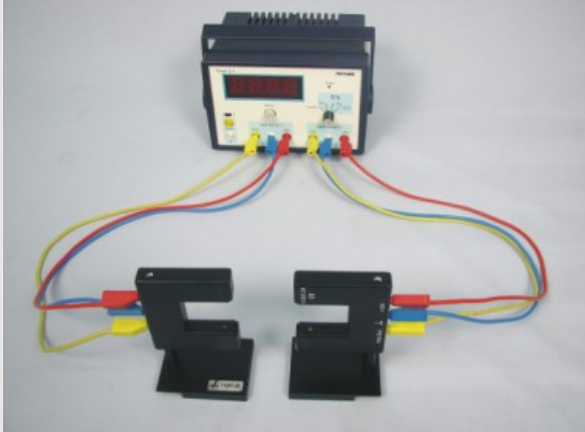
Подключение световых барьеров к таймеру
