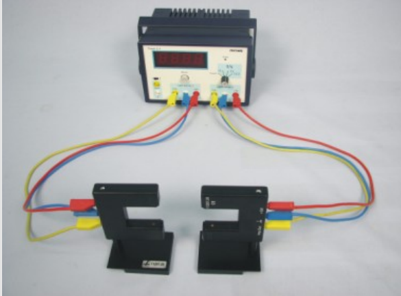
Lichtschranken mit dem Zeitmessgerät verbinden
