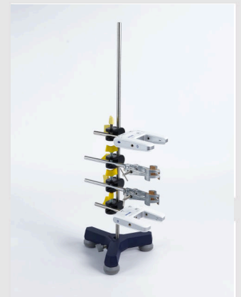
Lichtschranken an Doppelmuffen befestigen
