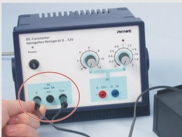
Podłączenie napięcia wyjściowego 12 V
