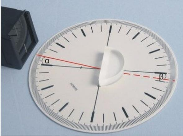
Determinación del ángulo de refracción
