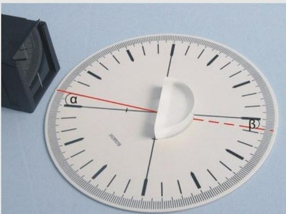
Determinación del ángulo de refracción
