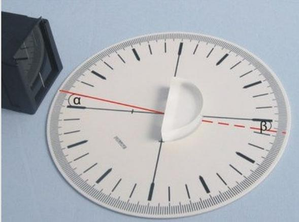
Détermination de l'angle de réfraction
