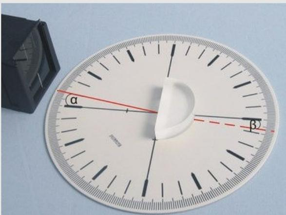
Détermination de l'angle de réfraction
