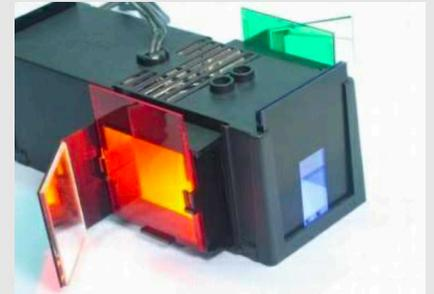
**Fig. 6:** Aumentar o disminuir ligeramente la distancia entre la caja de luz y el borde de plegado hasta que se pueda observar en la pantalla la mayor cantidad posible de colores mezclados.
