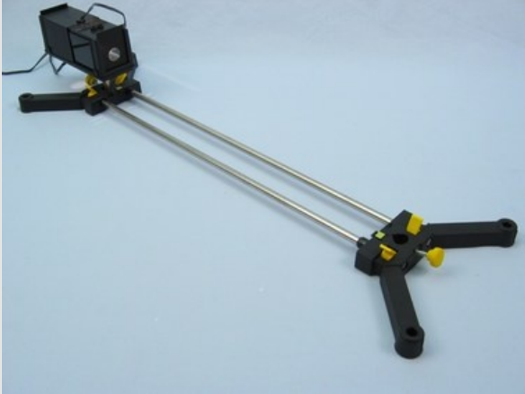
Расположение осветителя на оптической скамье
