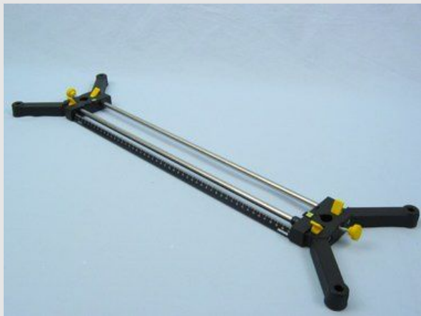
Montage du banc optique
