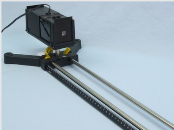
Расположение осветителя на оптической скамье
