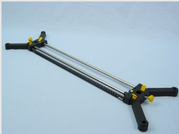
Сборка оптической скамьи
