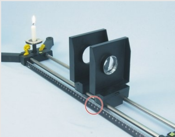
Medición de la distancia entre las dos lentes
