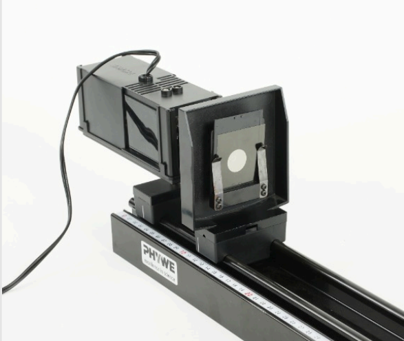
Polarisationsfilter im Blendenhalter auf der Fassung der Linse
