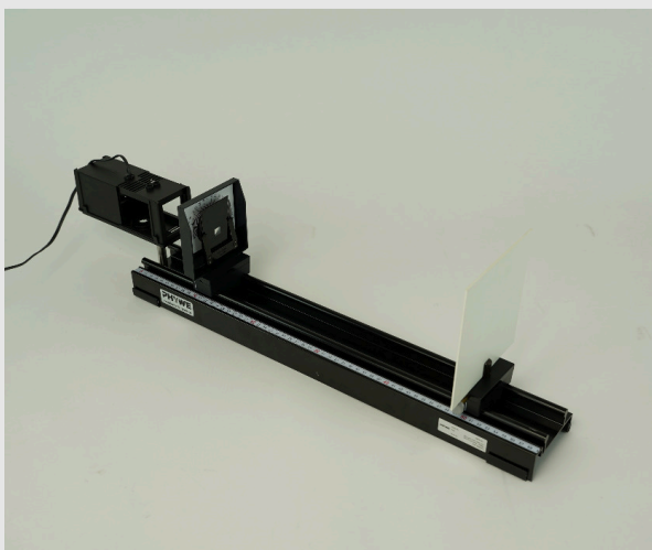
Оптическая скамья с осветителем, диафрагмой и экраном
