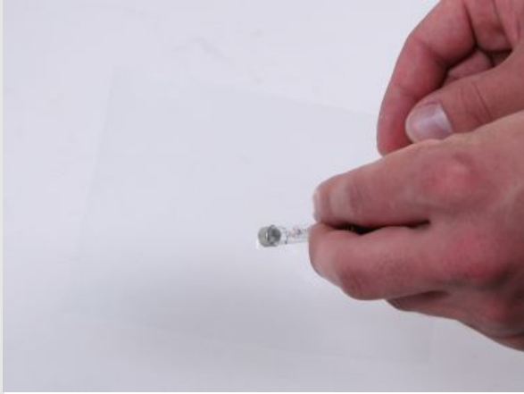
Folie und Metallkappe der Lampe zusammenführen
