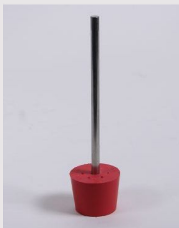
Stativstange in Gummistopfen stecken
