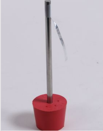
Leitfolienstreife an der Stativstange befestigen
