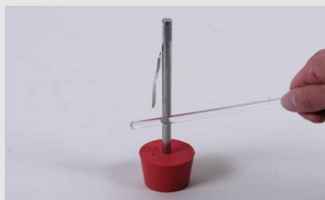
Проведите акриловым стержнем вдоль штативного стержня
