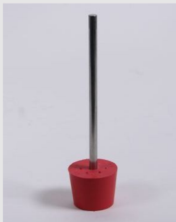
Вставьте штативный стержень в резиновую пробку
