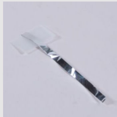
Скотч на полоске токопроводящей фольги
