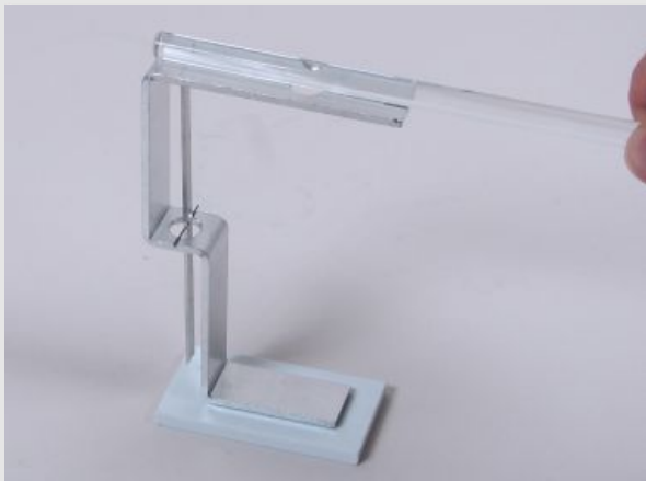
Перемещение акрилового стержня над электроскопом
