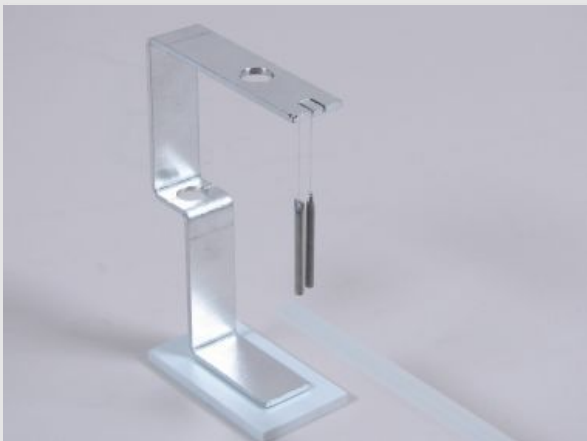
Polypropylenstab an Aluminiumröhrchen annähern
