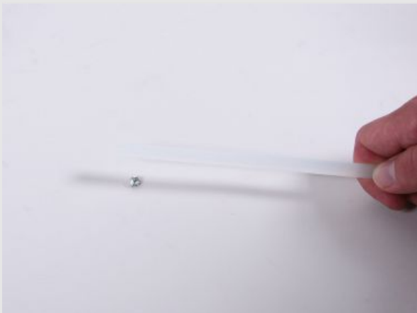
Versuch mit Polypropylenstab und Aluminiumkügelchen
