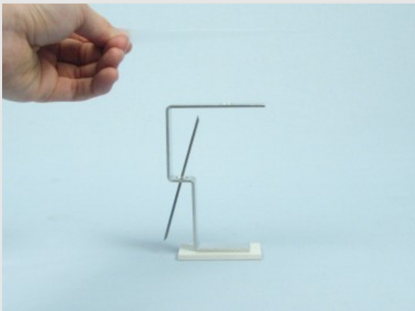
Aufgeladene Klarsichtfolie dem Elektroskop annähern
