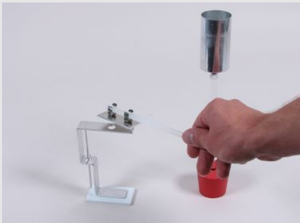
Поочередное прикосновение к чашке Фарадея и электроскопу
