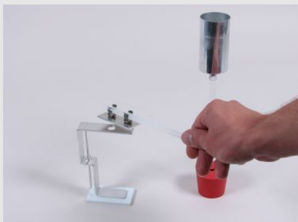
Поочередное прикосновение к чашке Фарадея и электроскопу
