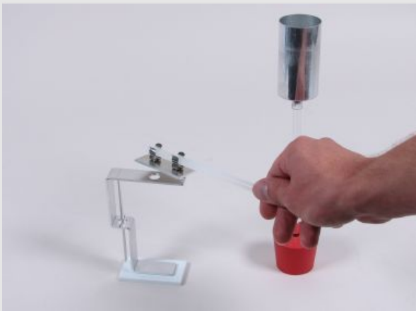
Wechselweises Berühren von Faraday-Becher und Elektroskop
