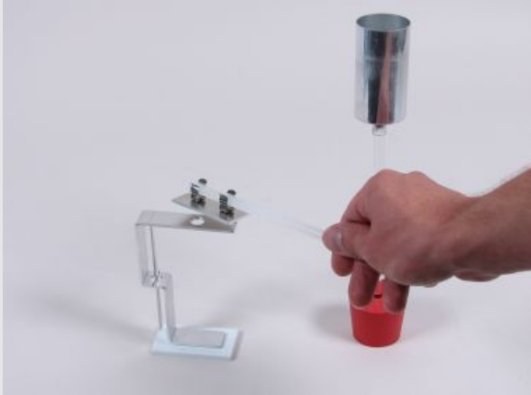
Wechselweises Berühren von Faraday-Becher und Elektroskop
