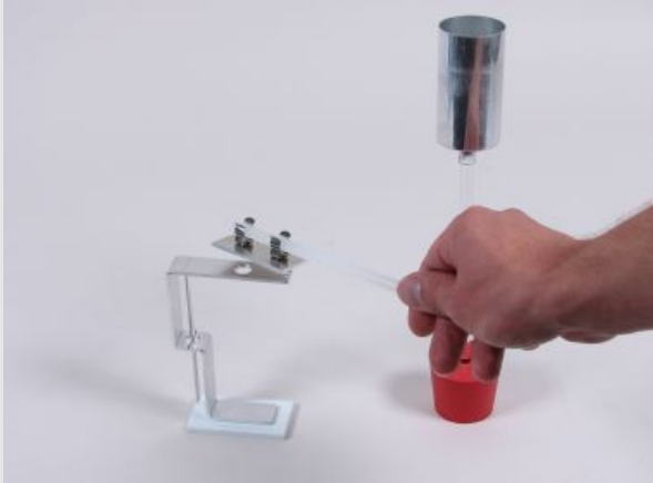
Wechselweises Berühren von Faraday-Becher und Elektroskop
