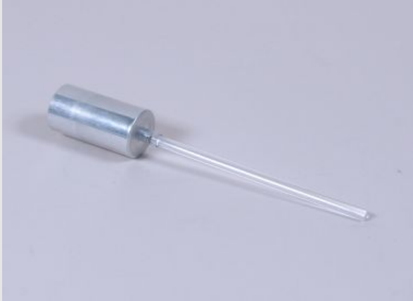
Faraday-Becher am Acrylstab befestigen
