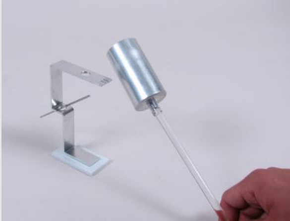
Approcher le b cher de Faraday de l lectroscope
