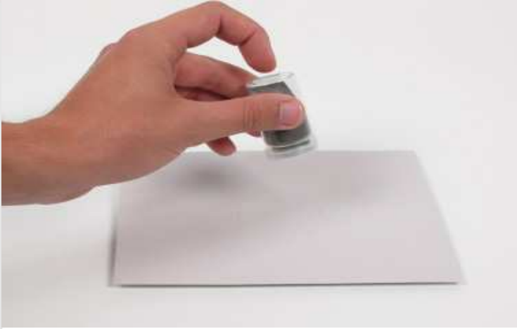
Durchführung - Bestreuen mit Eisenpulver
