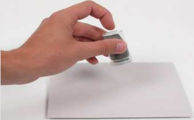
Uitvoering - bestrooien met ijzerpoeder
